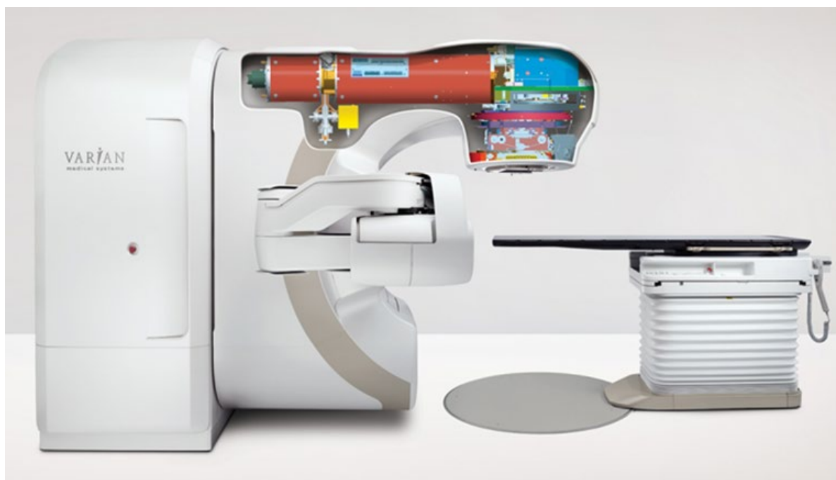
Figura: Illustrazione a taglio interno del sistema di distribuzione del fascio TrueBeam®
