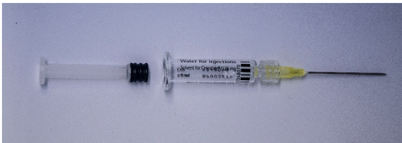
Figura 3. Pistone estratto completamente con perdita della sterilità
