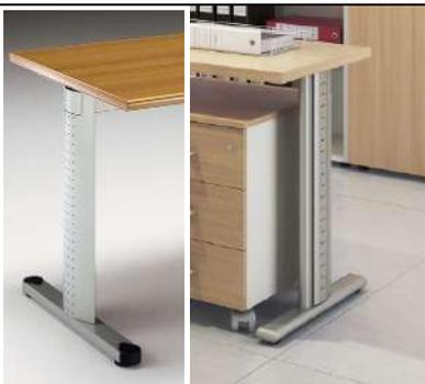
**Gamba scrivania** realizzata con piede di appoggio in scatolato d'acciaio rettangolare sezione 30x60x1.5 dotato di piedini regolabili, montante in lamiera d'acciaio 20/10 mm, verniciata a polveri epossidiche dotata di carter in lamiera con chiusura a scatto e vano per la salita dei cablaggi. Puntali del piede in plastica stampata colore antracite.
