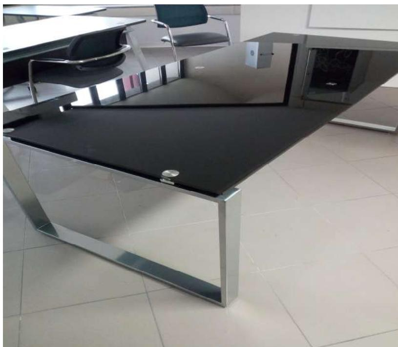
**Gamba tavolo riunione** realizzata con piede di appoggio in scatolato d'acciaio rettangolare sezione 30x60x1.5 dotato di piedini regolabili, montante in lamiera d'acciaio 20/10 mm, verniciata a polveri epossidiche dotata di carter in lamiera con chiusura a
